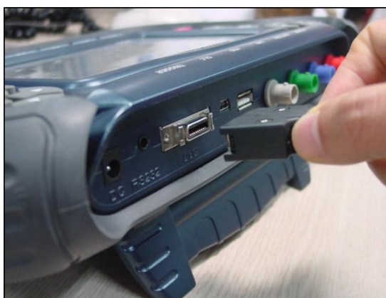
[ Рис. Подсоединение кабеля к X-1 DLC Коннектору ]
