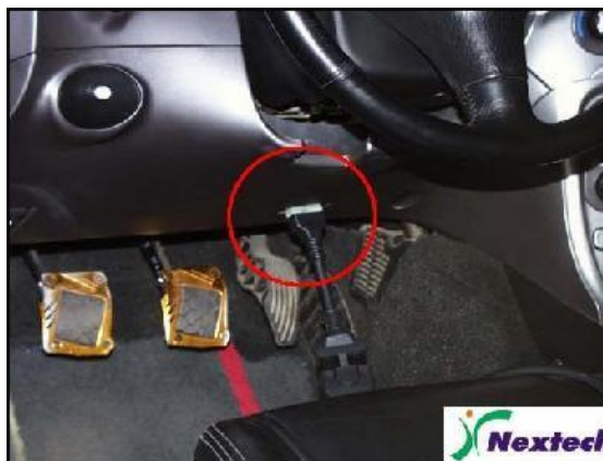
[ Рис. X-2 Подсоединение к Автомобилю ]
